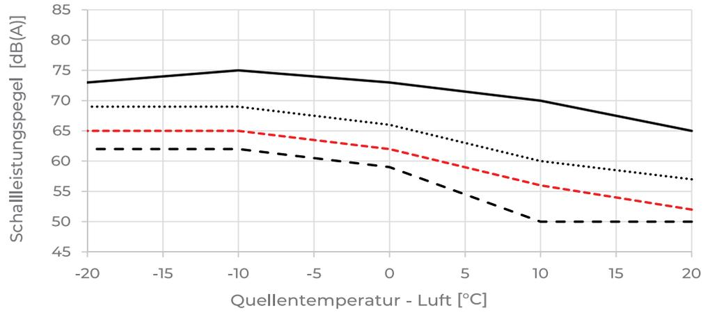
Schalldruckpegel - maximale Heizleistung
