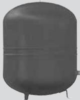
Alle Ausdehnungsgefäße sind gegenüber der Heizungsanlage absperrbar anzuordnen. Absperrrichtungen müssen ausreichend gegen unbeabsichtigtes Schließen gesichert sein (z. B. Kappenventil mit Draht und Plombe gesichert). Membranausdehnungsgefäße müssen EN 13831 entsprechen. Ausdehnungsgefäße sind in frostfreien Räumen aufzustellen oder gegen Einfrieren zu schützen. Ausdehnungsgefäße sind gem. DIN EN 12828 auszulegen.
