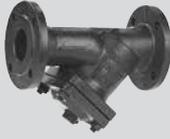
in Flansch-/Schrägsitzausführung mit eingebautem Niro-Edelstahlsieb, Feinfilter [Maschenweite 0,25 bis 0,5mm] mit Entleerungsschraube, Korrosionsschutz durch Pulverbeschichtung, für Einbaulage: horizontal oder vertikal.
