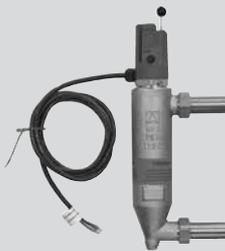
Wassermangelsicherung kann an die Kesselregelung angeschlossen werden. Bei Absinken des Wasserstands wird der Kessel dann verriegelnd abgeschaltet.
