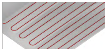
SOLE-WASSER - HORIZONTALER ERDKOLLEKTOR
