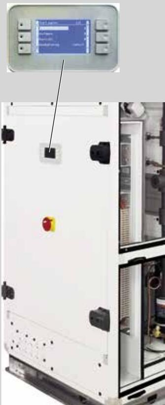
Die werkseitig montierte und verdrahtete, mikroprozessorgesteuerte Regelung mit Trennschalter am Gerät steuert und regelt Ventilatoren, Verdichter, Wärmerückgewinnung, Temperaturen, Volumenströme, Betriebszeiten und eine Vielzahl an internen Funktionen sowie Alarmfunktionen.
